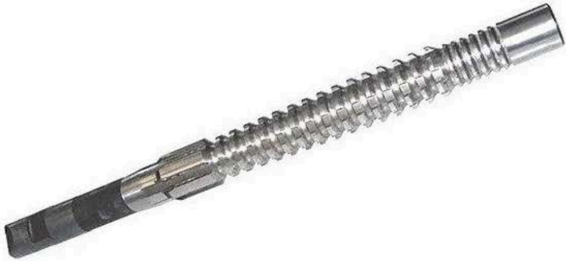
Рисунок 1.6 – Протяжка шпільова Д10×72×82 1 75-150 Р6М5
