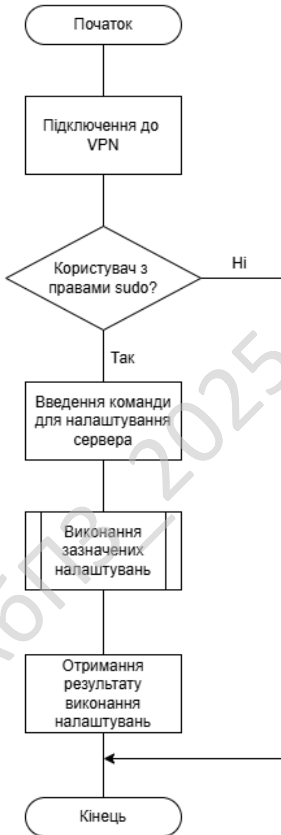
Рисунок 4.2 – Блок-схема взаємодії адміністратора з програмним забезпеченням
