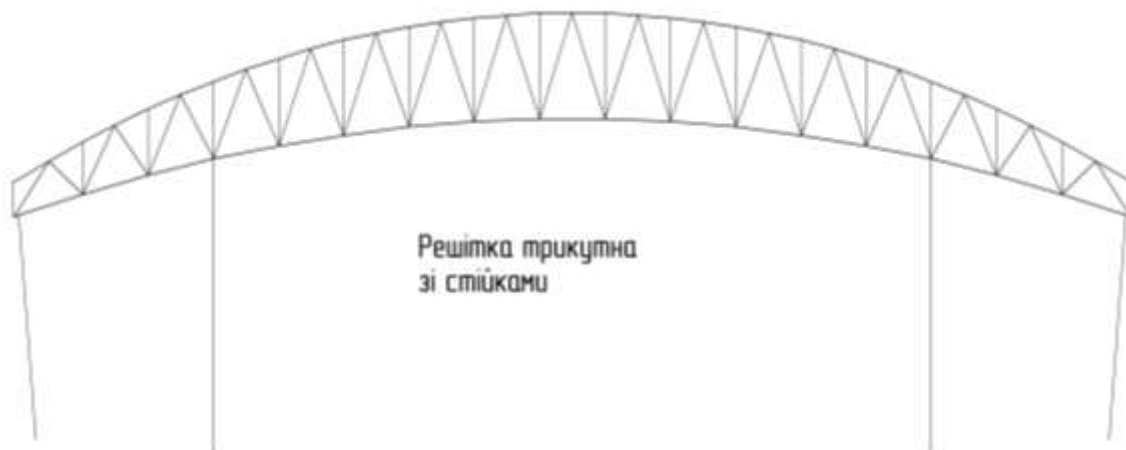
Рисунок 4.2 Схема рами з трикутною решіткою і стійками.
