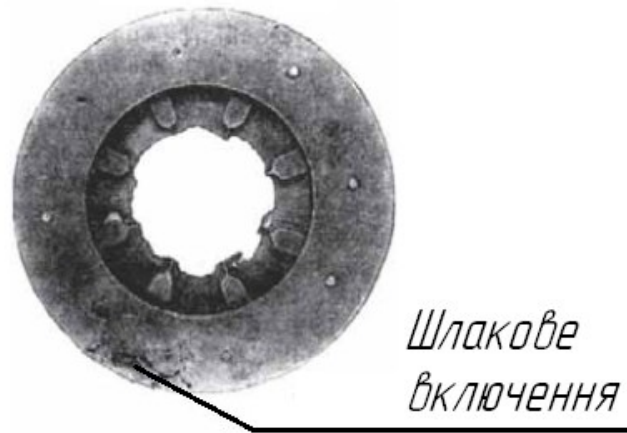
Рисунок 3.1 – Поверхнєве шлакове включення в чавунному виливку диска зчеплення вантажного автомобіля
