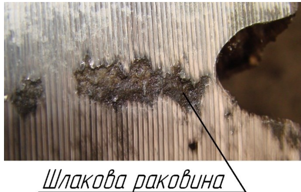
Рисунок 3.2 – Поверхнева велика шлакова раковина в чавунному виливку кришки насоса
