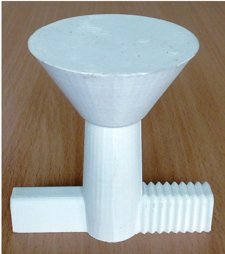
Рисунок 3.21 – Надруковані на 3D-принтері моделі ЛЖС з ребристим шлаковловлювачем
