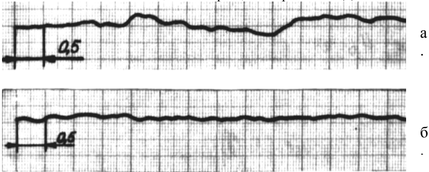
Рис. 4.9. Профіль обробленої поверхні поперек (а) і вздовж (б) слідів
