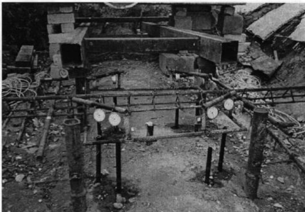
Рис. 2.10 Установка прогібомірів на реперній системі.
