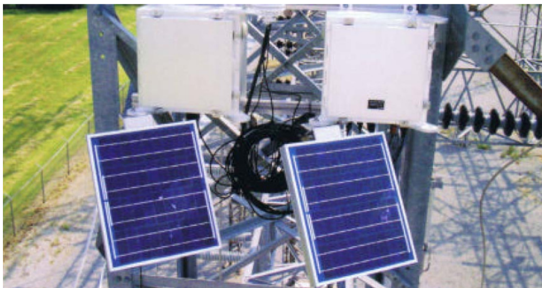
Рис. 1.9. Основний модуль САТ-1 та модуль живлення
