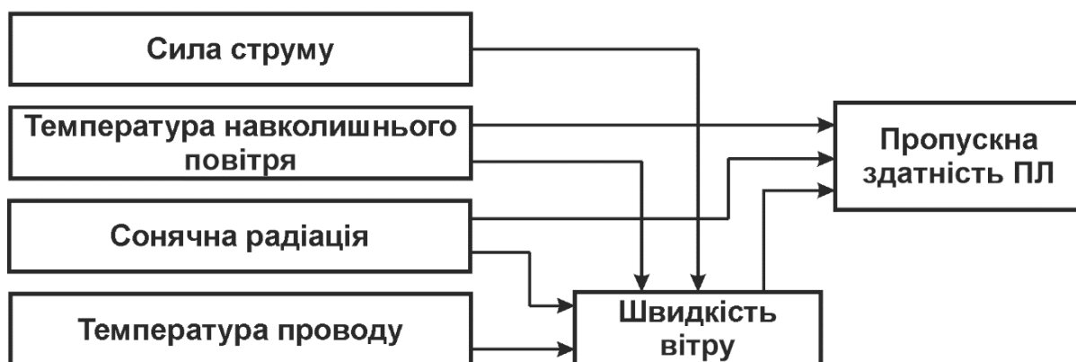
Рис. 1.3. Реалізація підходу DLR: «температура проводу та метеорологічні параметри»
