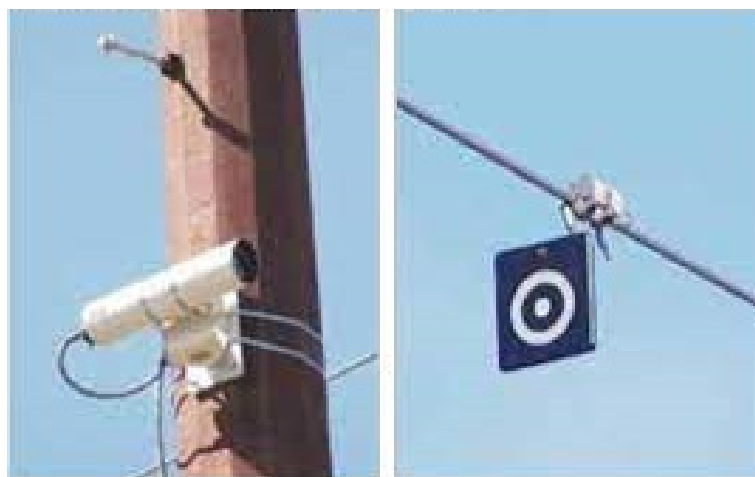
Рис. 1.11. Камера та мішень системи Sagometer
