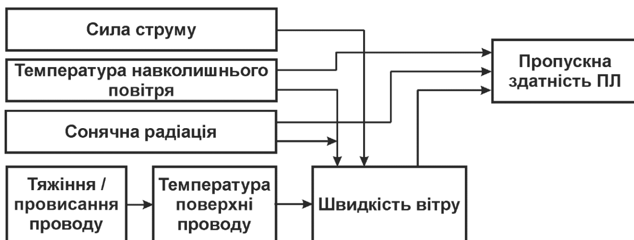
Рис. 1.4. Реалізація підходу DLR: «тяжіння / провисання проводу та метеорологічні параметри»
