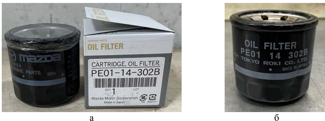
а – фільтр новий з коробкою для зберігання; б – фільтр перевірений та замінений через 10175 км
