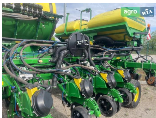
Рис. 2.8 –Загальний вигляд сівалки DB37 від John Deere
