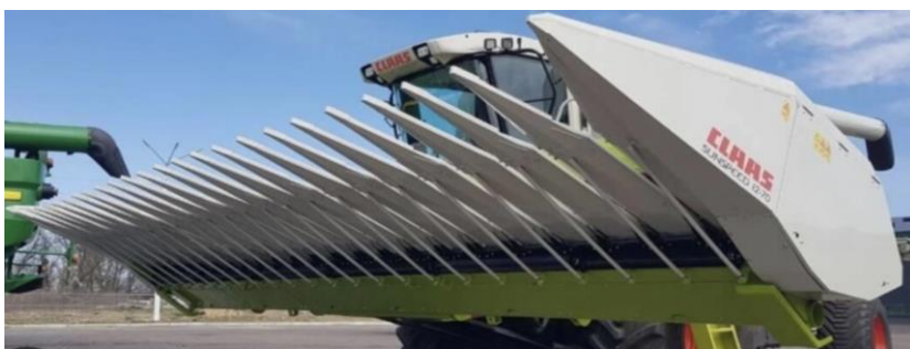
Рис. 2.11 – Загальний вигляд спецжатки для збирання соняшника SUNSPEED 12-70 від CLAAS
