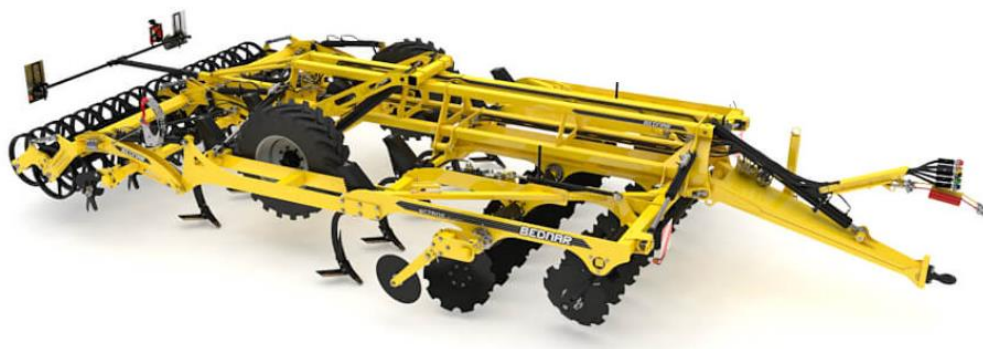
Рис. 2.4 – Дисколаповий культиватор ACTROS RO від BEDNAR
