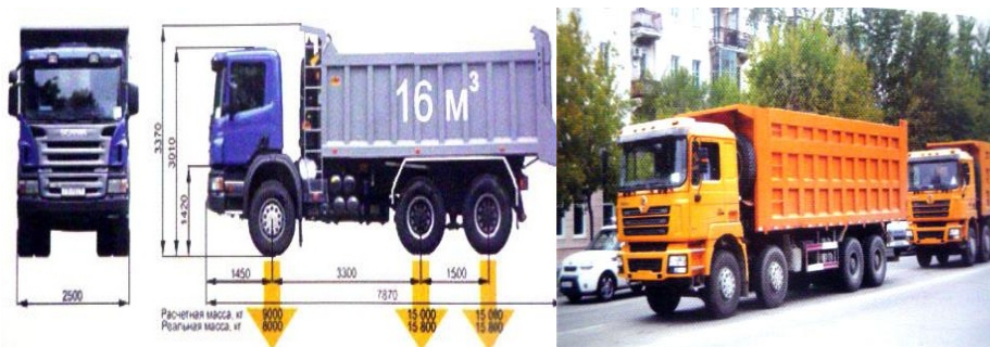
Рис.3. Параметри тривісного самоскида та загальний вигляд чотиривісного самоскида загальною масою 60т.
