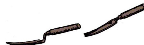
Рис.3. Інструмент – розшивка, відповідно для випуклих і ввігнутих швів.
