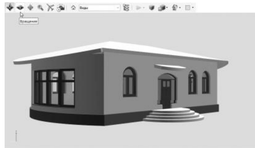
Рис. 1. Зображення 3D-моделі проекту будинку, створеного в програмах ArchiCAD та Allplan, експортованого у форматі 3D PDF та відкритого у середовищі програми Adobe Reader 9
