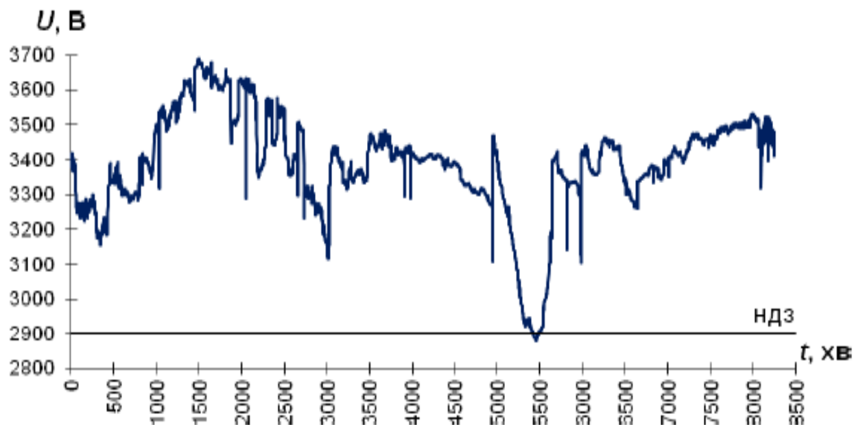
Рис. 7.10. Напруга на струмоприймачах потягу у режимі вибігу
