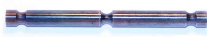
Рис.8.2. Зовнішній вигляд циліндричного зразка з концентратором напружень
