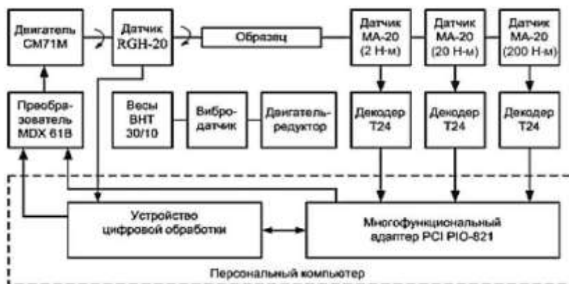
Рис.4.5. Блок-схема установки ТТМ-200
