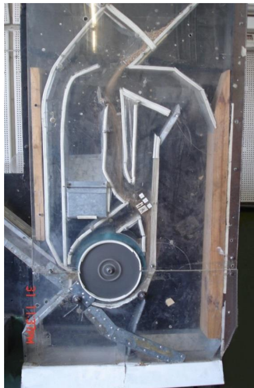
Рис. 2.4. Експериментальна установка інерційного сепаратора
