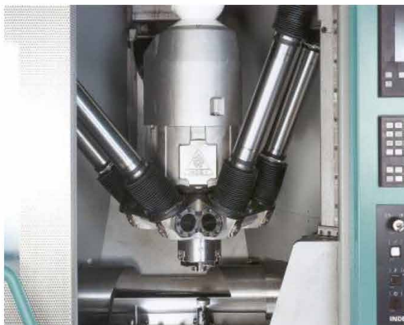
Рис. 1.6. Верстат з паралельною кінематикою мод. INDEX V 100
