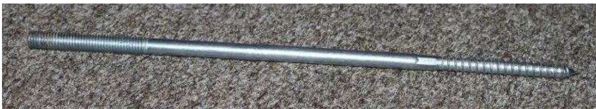
Рисунок 18 – Загальний вигляд анкерної різьбової шпильки
