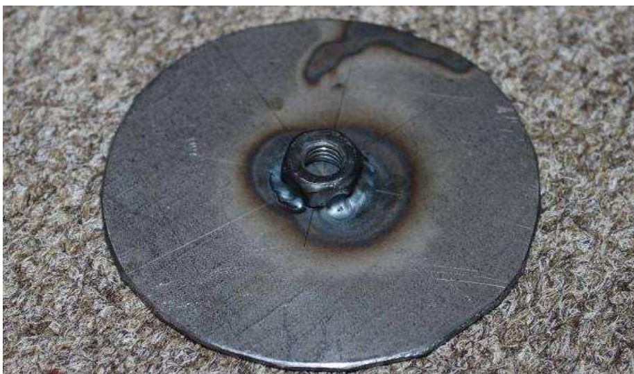
Рисунок 19 – Загальний вигляд зворотної частини анкерної різьбової шпильки
