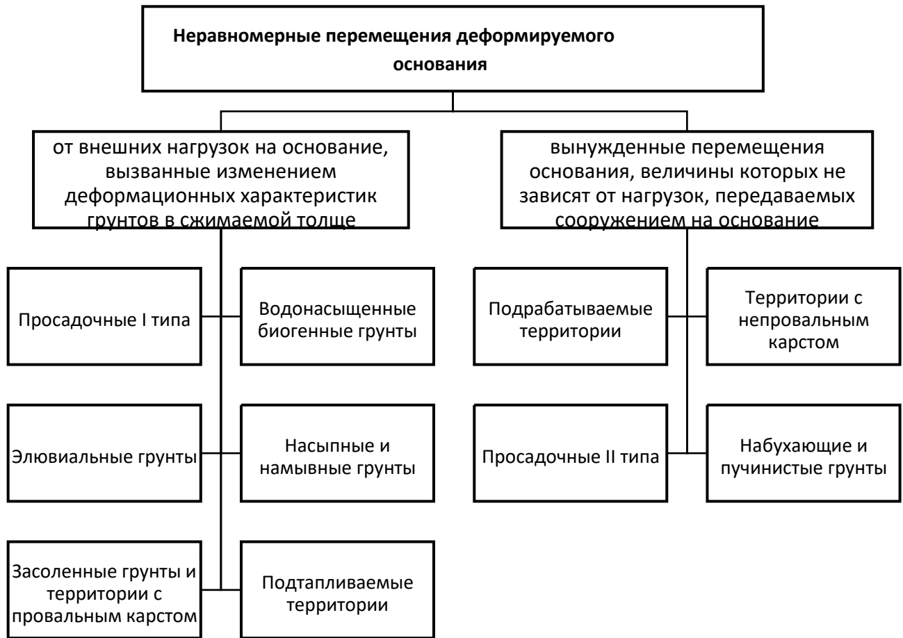
Рис. 2.2 – Систематизація різноманітних складних геологічних умов за типом нерівномірних рухів ґрунту, що можуть призвести до деформацій будівель та споруд.
