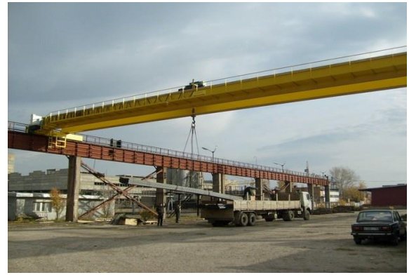
Рис. 1.2 Двобалкові електричні мостові крани
