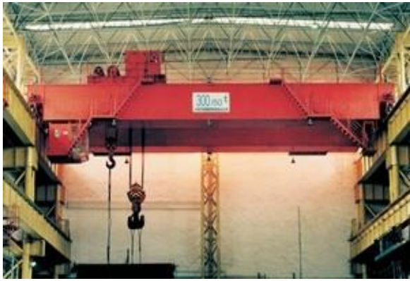
Рис. 1.2 Двобалкові електричні мостові крани
