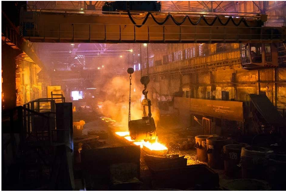
Рис. 1.1 – Переміщення ковша з розплавленою сталлю за допомогою мостового крану
