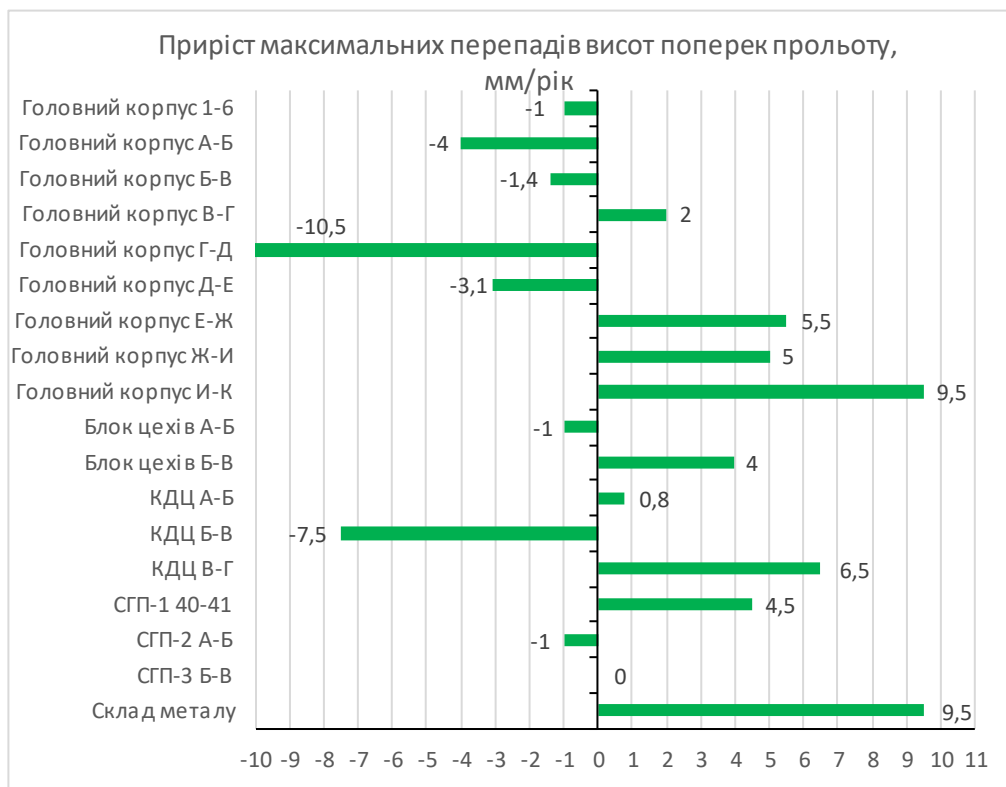
Рис. 4.9 – Швидкість зростання максимальних перепадів висот головок кранових рейок поперек прольоту
