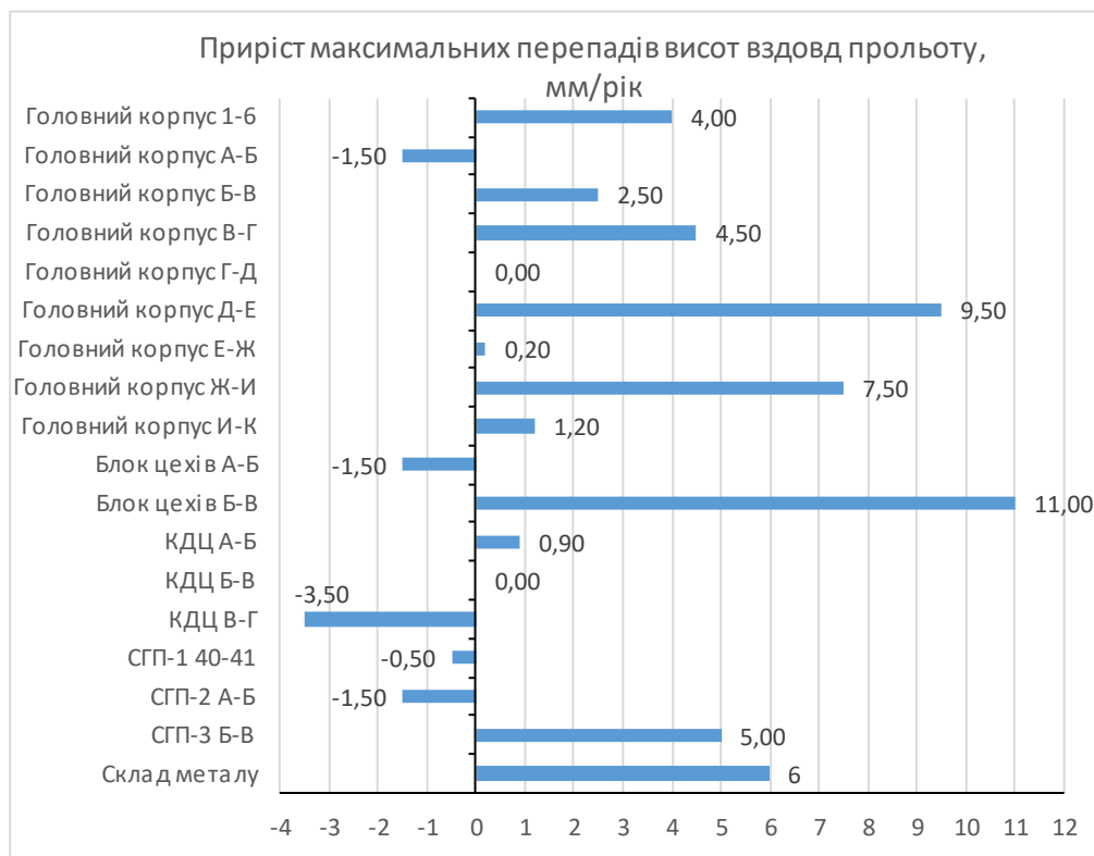
Рис. 4.2 – Швидкість зростання максимальних перепадів висот головок кранових рейок уздовж прольоту
