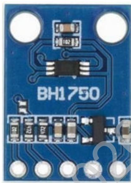
Рисунок 4.7 – Цифровий сенсор BH1750
