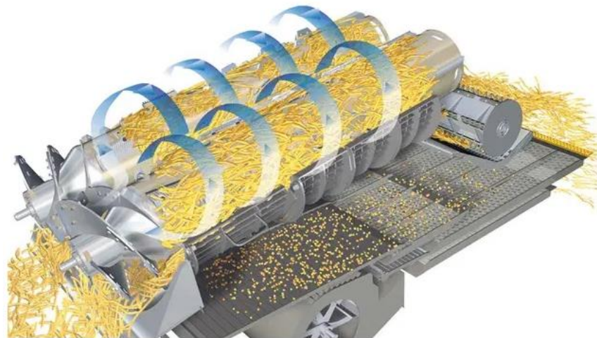
Рис. 2.4. Роторний молотильний апарат з системою очистки зерна
