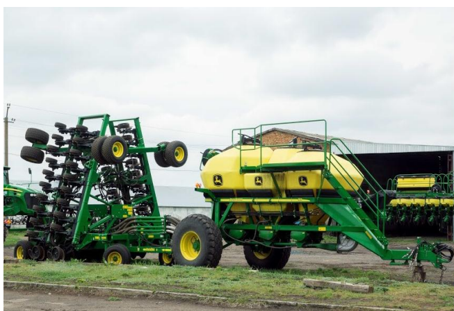
Рисунок 1.11 – Посівний комплекс культиватори, John Deere 1890+1910
