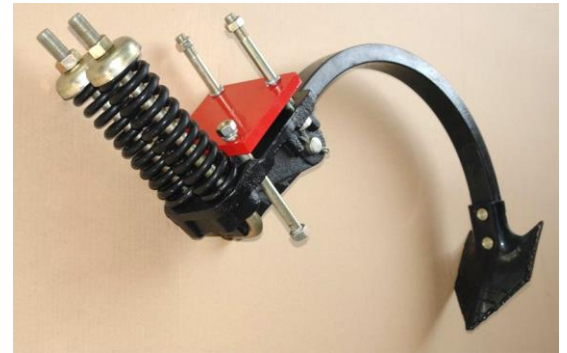
Рис. 2.9. Робочий орган з запобіжним пристроєм
