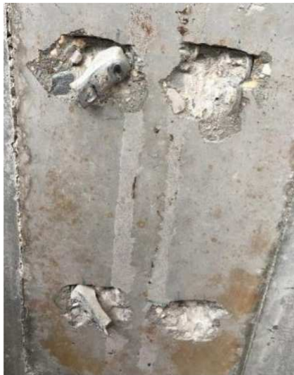
Рисунок 49 – Руйнування зразка внаслідок деформації упорів
