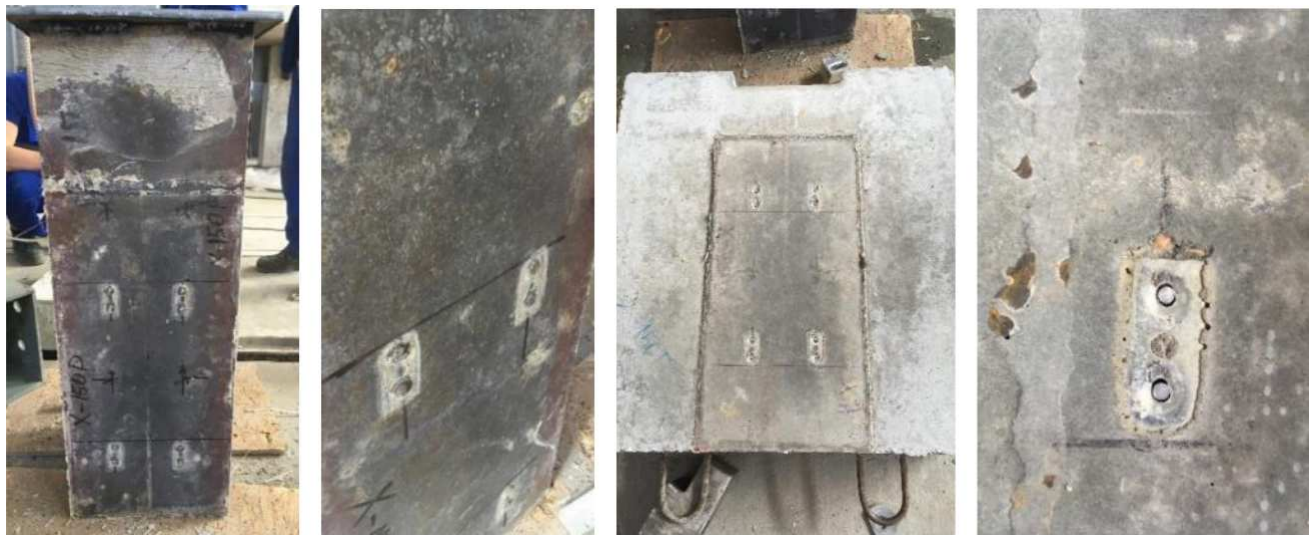
Рисунок 41 – Механізм руйнування конструкції об'єднання в зразку Х-150Р; а, б – вид сталеві балки після випробування; в, г – вид залізобетонної плити після випробування.
