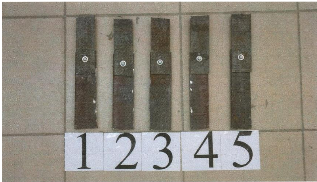
Рисунок 28 – Зовнішній вигляд зразків для випробування дюбель-цвяхів на зрушення
