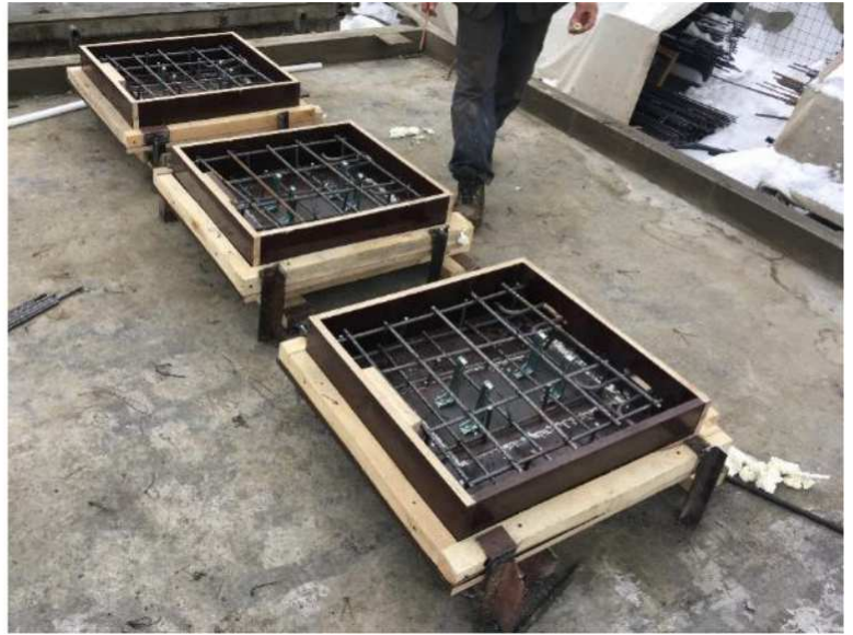
Рисунок 31 – Зразки для другого етапу випробувань перед заливанням бетону
