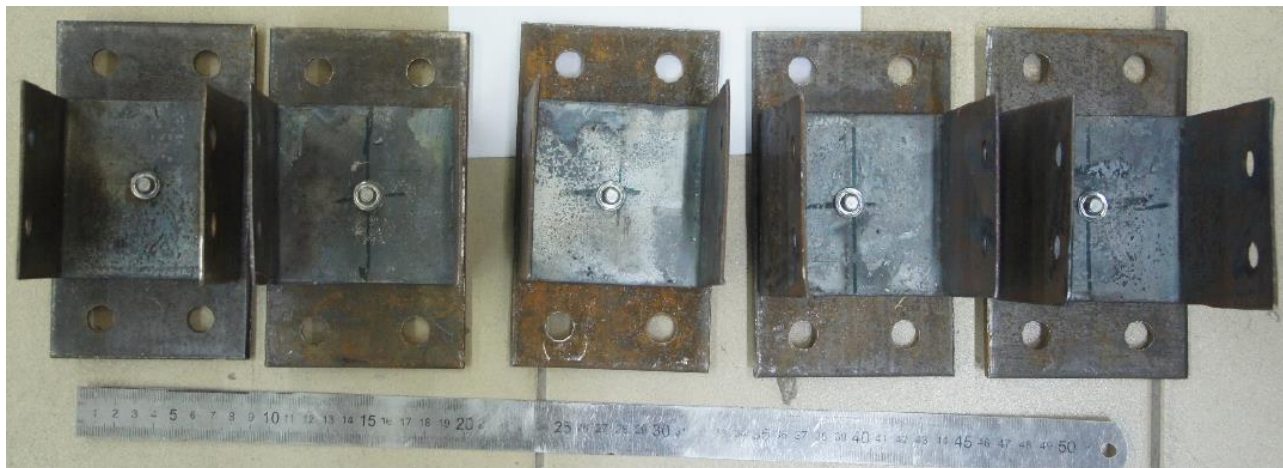
Рисунок 29 – Зовнішній вигляд зразків для випробування дюбель-цвяхів на розтягання
