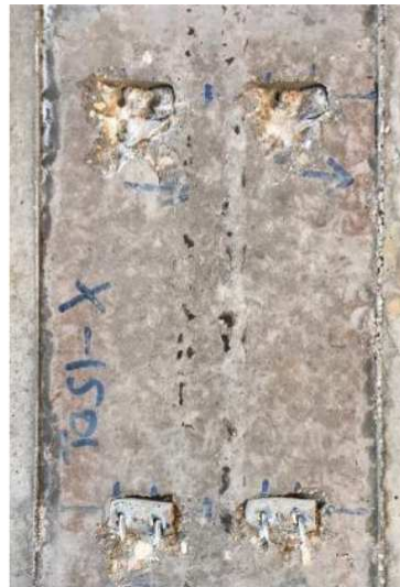
Рисунок 50 – Нижня пари упорів вийшла з ладу внаслідок вириву дюбелів з основи
