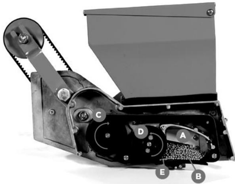
Рис. 3.3. Висівний апарат стрічковий «Stanhay»: А – дросель; В – пасок насіння; С – приводне колесо; D – колесо відбивача; Е – пружина.
