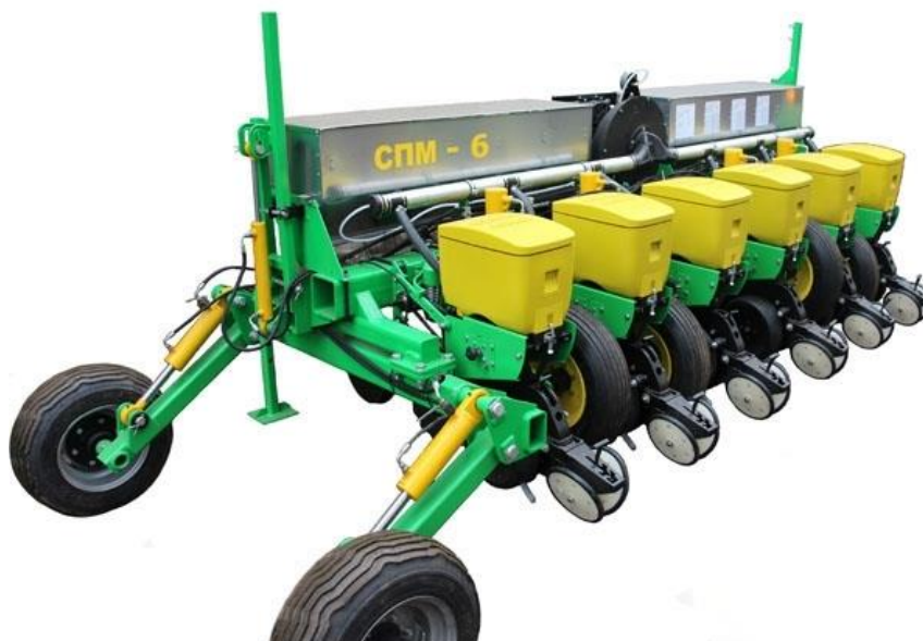
Рис. 2.3. Сівалка точного висіву SPM 6 просапна пневматична
