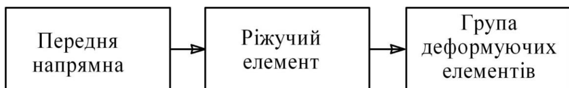
Рис. 2.1 – Схема деформуюче-ріжуче-деформуючої протяжки для обробки деталей із чавуну
