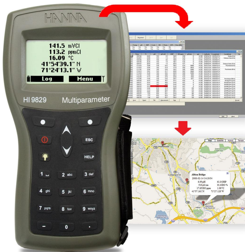
Рисунок 4.7 - Обробка даних, надісланих аналізатором HI 9829-01202
