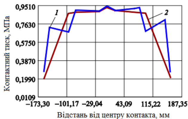
Рис.3.17. Розподіл контактного тиску поперек відбитка шин 16,00R20 (1) і 445/85R24 (2)
