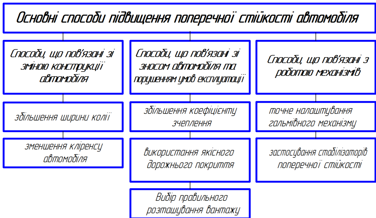
Рис.2.2. Класифікація способів підвищення стійкості автомобіля
