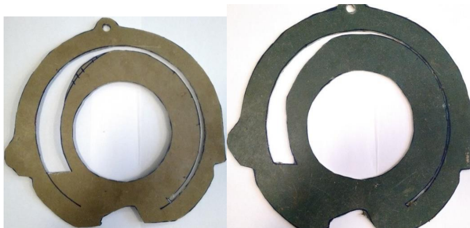
Рис. 3.10 – Фото виготовленої для експериментів прокладки вакуумкамери
