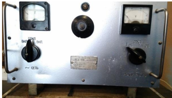
Рис. 3.8 – Фото регулятора-випрямляча струму «ВСА-111к»
