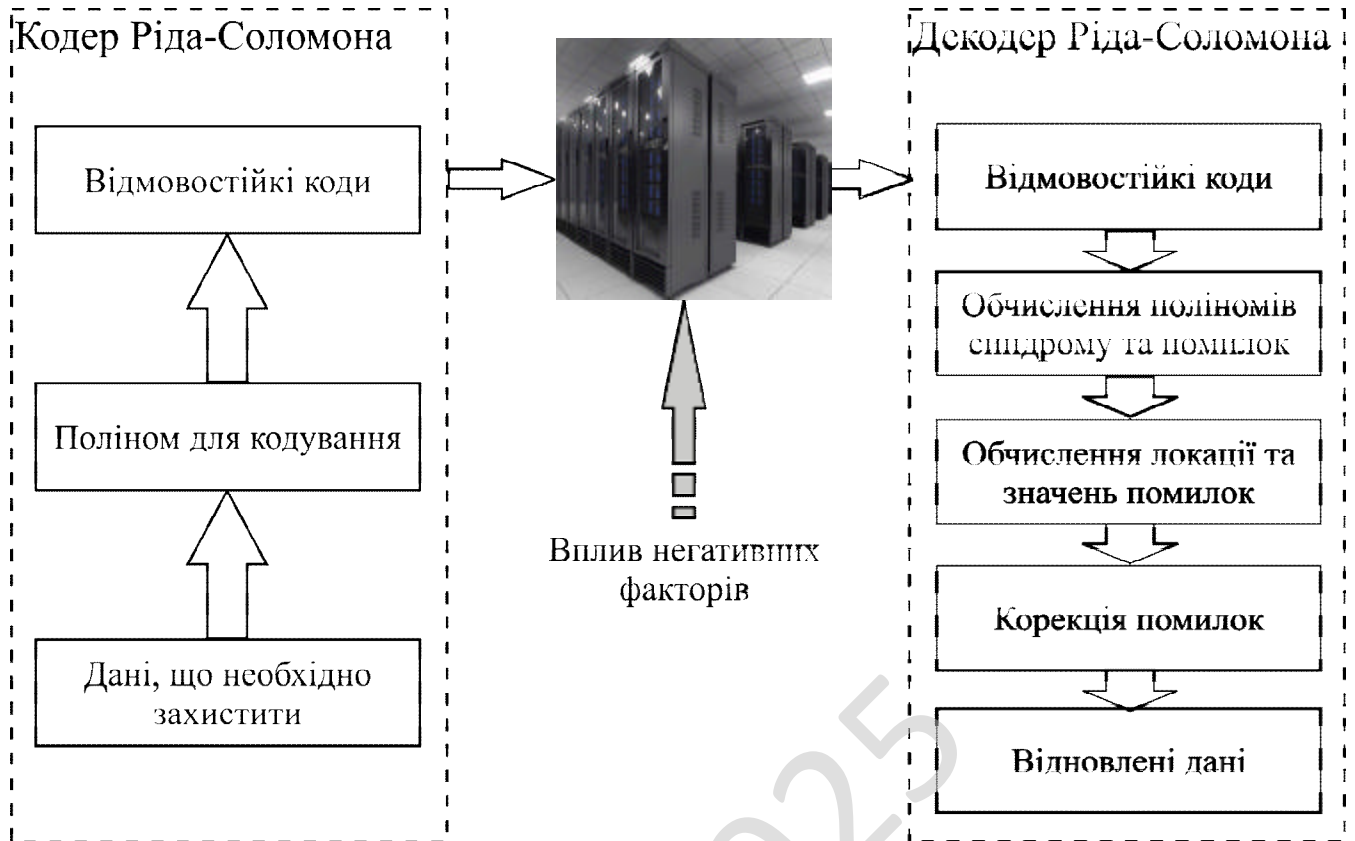
Рисунок 3.2 – Функціональна схема системи
