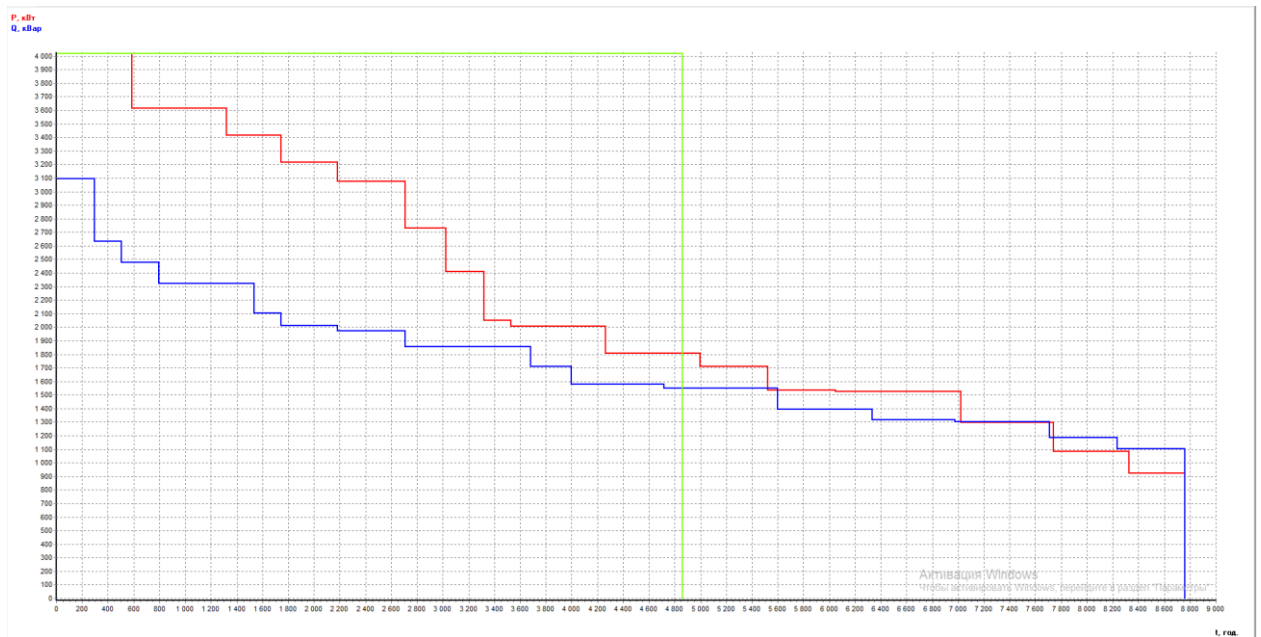
Рисунок 2.5 – Річний графік активної та реактивної енергії по тривалості комбикормового заводу.
