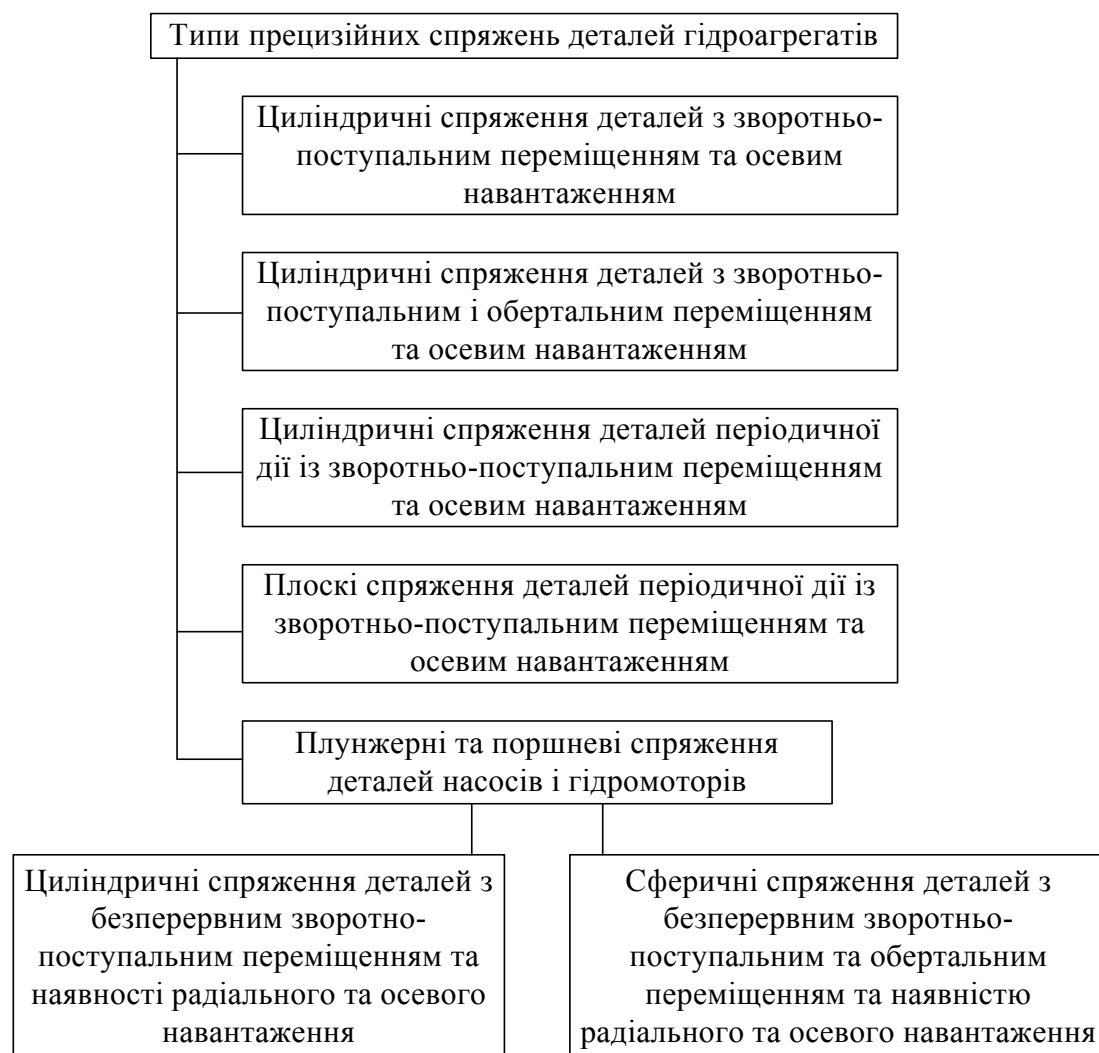
Рисунок 1 – Блок-схема існуючих типів прецизійних спряжень деталей гідроагрегатів
