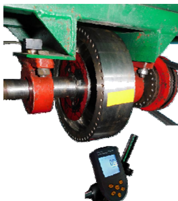
Рисунок 2 – Динамічне балансування валу Резонансна вібраційна машина
