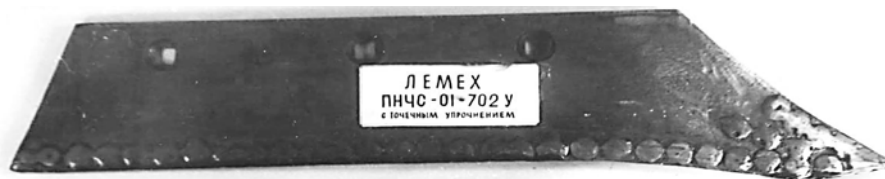
Рисунок 2 – Леміш ПНЧС01-702У серійний, наробіток 29,2 га
