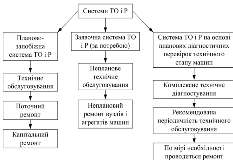
Рисунок 1 – Системи технічного обслуговування і ремонту транспортної техніки
