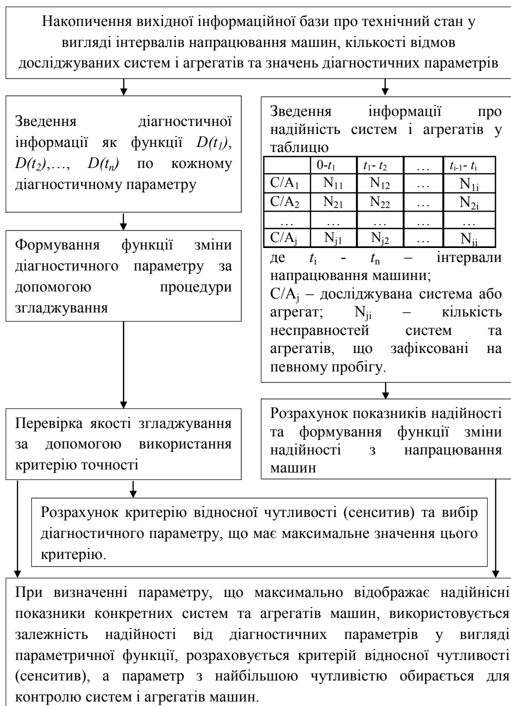
Рисунок 1 – Блок-схема методу визначення характеру динамічного розвитку діагностичних параметрів та показників надійності технічного стану систем і агрегатів машин
