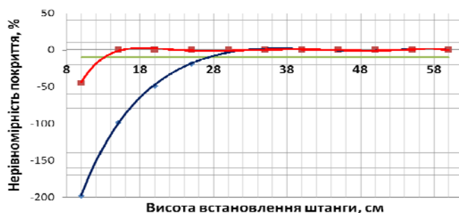
Рисунок 3 – Графічні залежності нерівномірності покриття для розпилювачів
