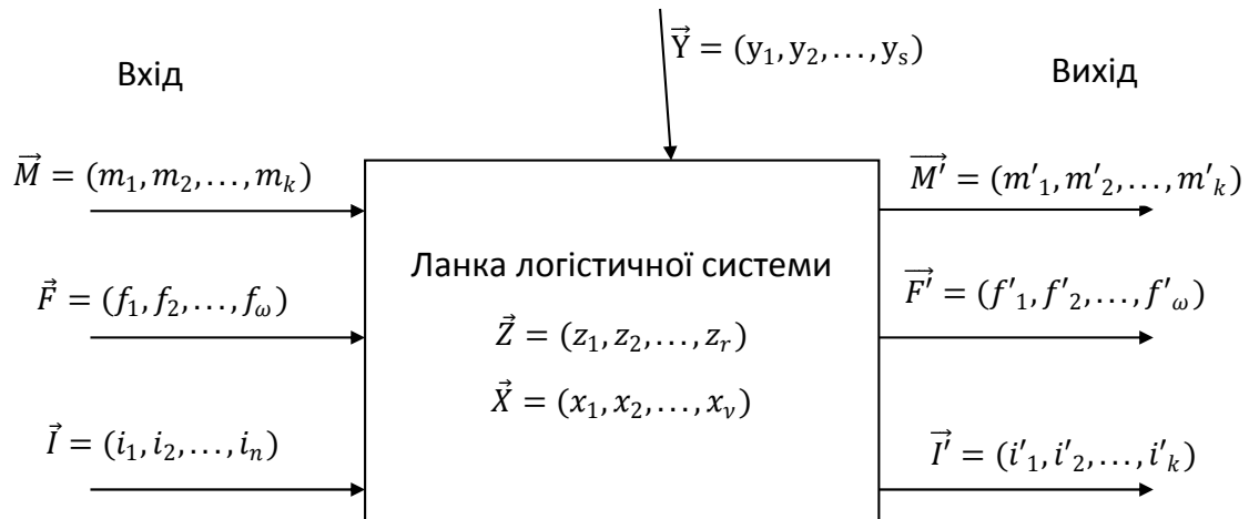
Рисунок 2 – Схема ланки логістичної системи, як перетворювача потоків
