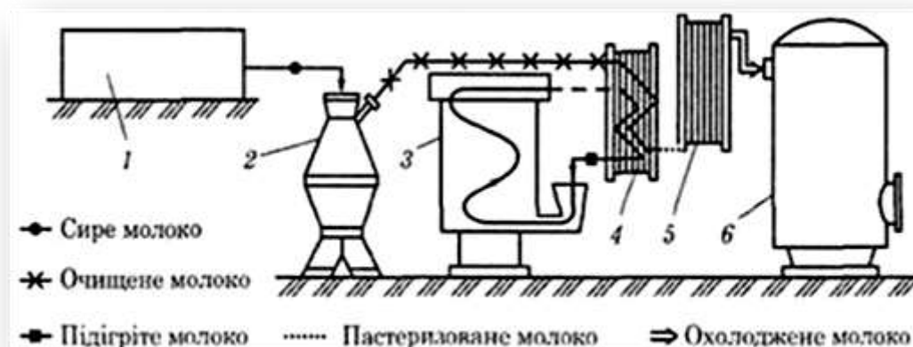
Рисунок 2.1 – Технологічна схема первинної обробки молока: 1 – молокозбірник; 2 – сепаратор-очисник; 3 – пастеризатор; 4 – регенеративний теплообмінник; 5 – охолодник; 6 – молочний танк
