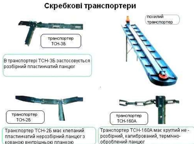
Рисунок 3.2 – Ланцюги скребкових транспортерів та їх характеристика
