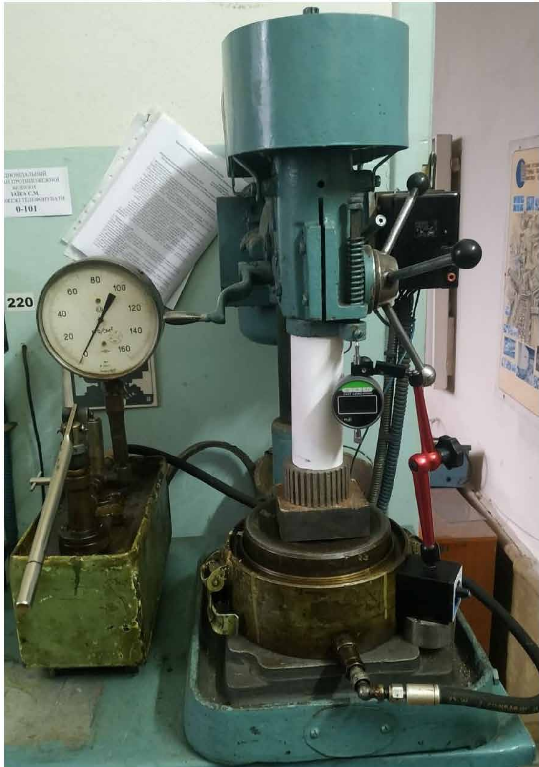
Рис. 4.3. Принцип навантаження станини верстата для визначення пружних деформацій під час процесу РОД.
