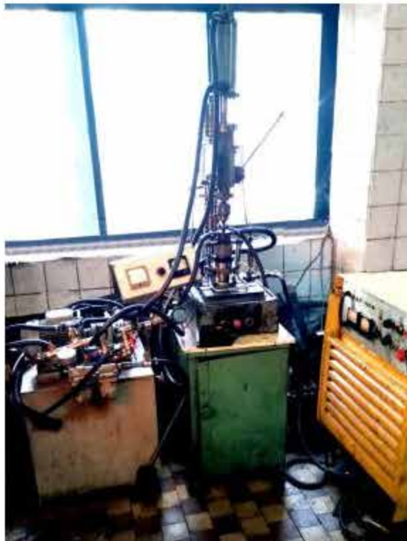
Рис.2.2. Установа РОД з використанням ЕЕГ встановленої на настільному свердлувальному верстаті
