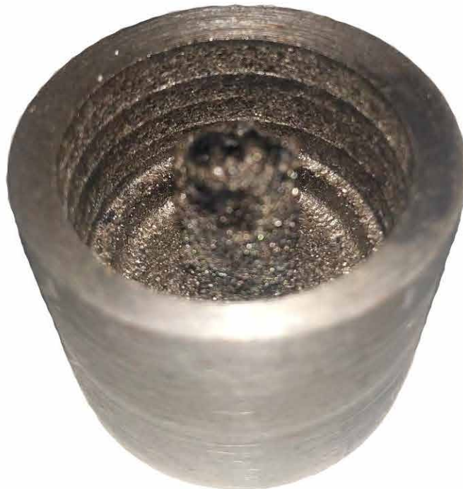
Рис. 4.6. Дефект від короткого замикання викликаний пружними деформаціями станини верстата під час процесу РОД.
