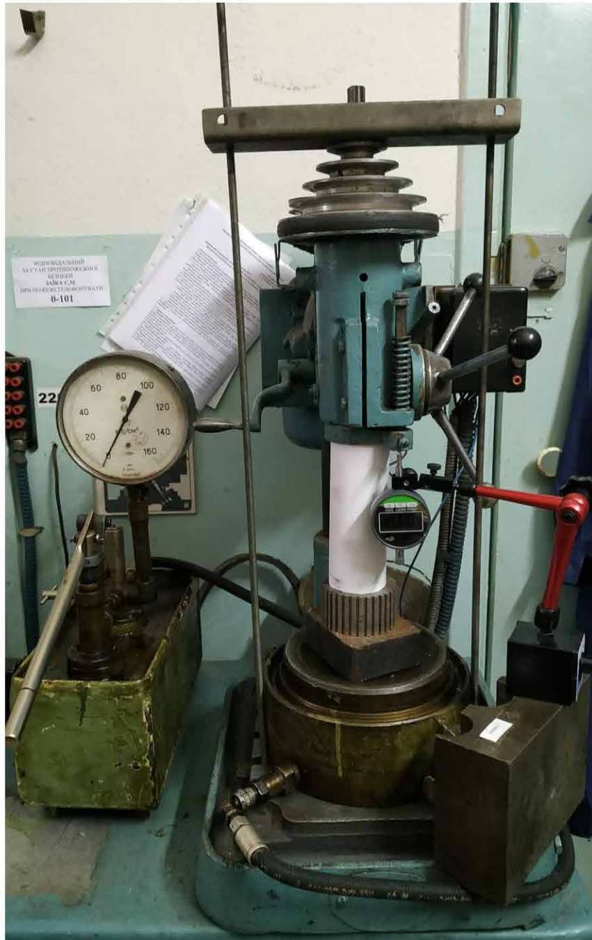
Рис. 4.7. Навантаження станини верстата з встановленими стяжками для визначення пружних деформацій під час процесу РОД.
