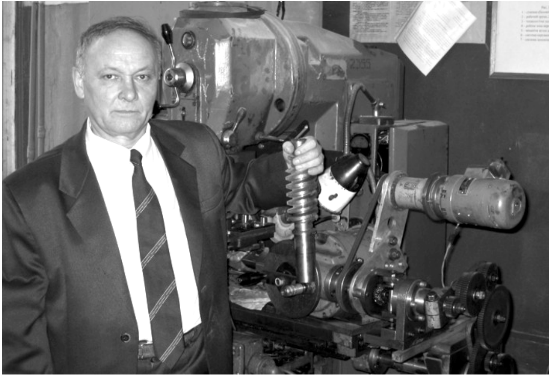
Надсеїн В.С. демонструє дослідний зразок черв'яка, виготовлений на модернізованому верстаті у лабораторії металорізальних верстатів та верстатів з паралельною кінематикою (лаб. № 118)
