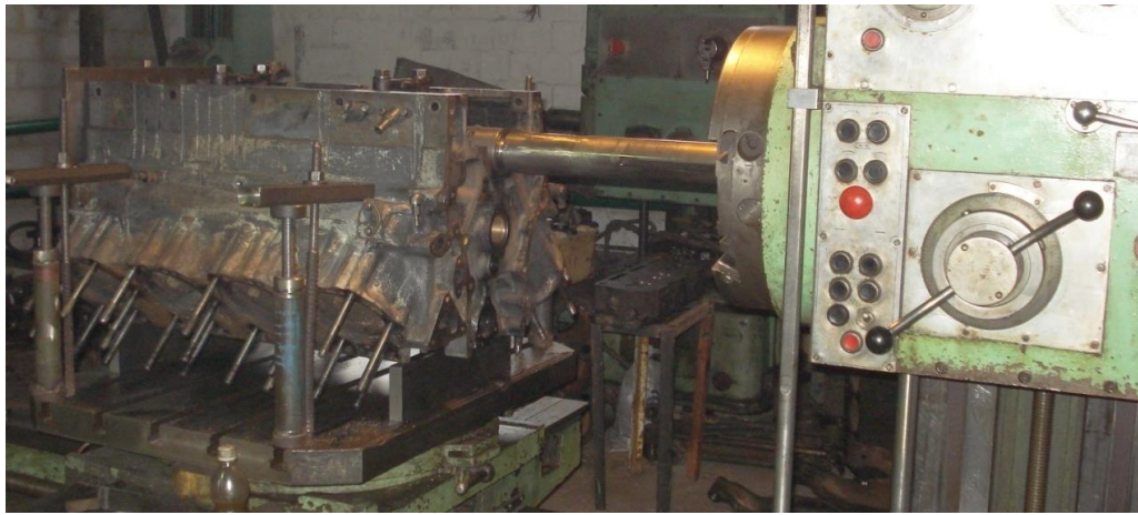
Рисунок 5.3 – Схема (а) та процес (б) розточування корінних опор під номінальний розмір на горизонтально-розточному верстаті
