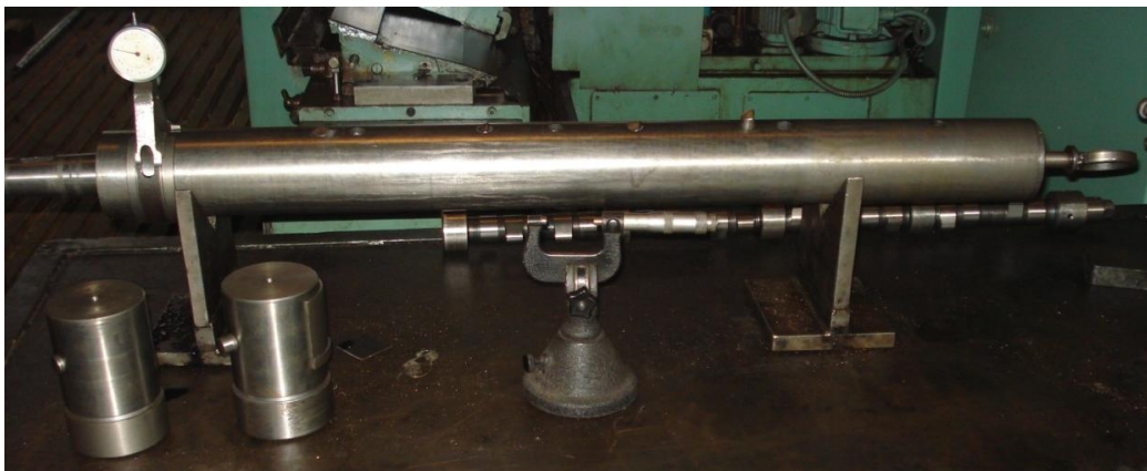
Рисунок 5.4 – Налаштування різців борштанги на розмір
