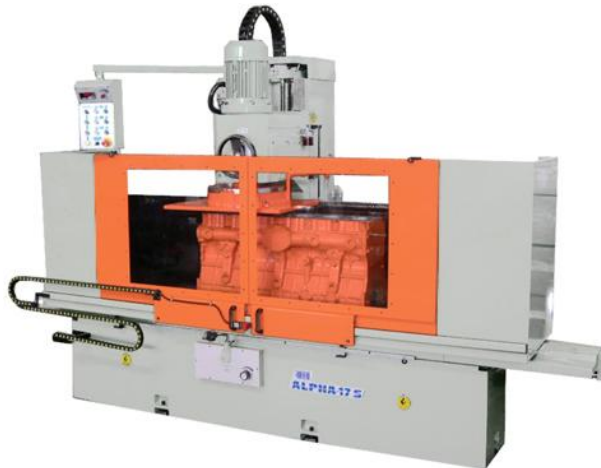
Рисунок 12.5 – Верстат для фрезерування площини прилягання.
