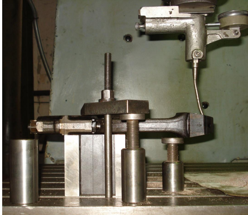
Рисунок 8.6 – Базування деталі при розточуванні.
