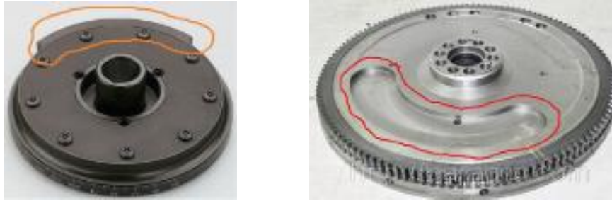
Рисунок 13.10 – Зовнішній вигляд маховика і переднього шківів при зовнішньому балансуванні.
