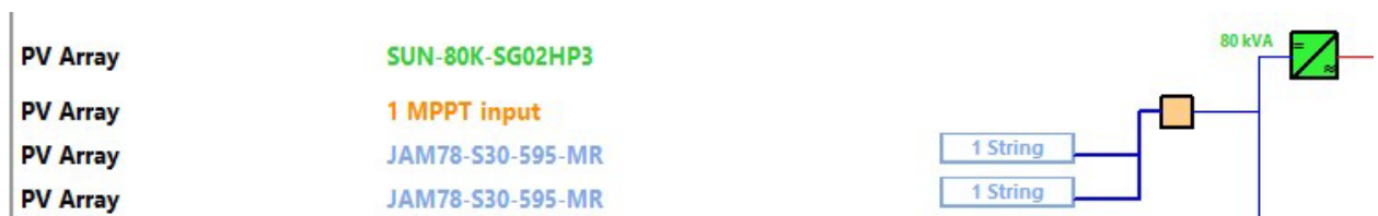
Рис.2.15. Схема підключення PV-панелей до одного MPPT
