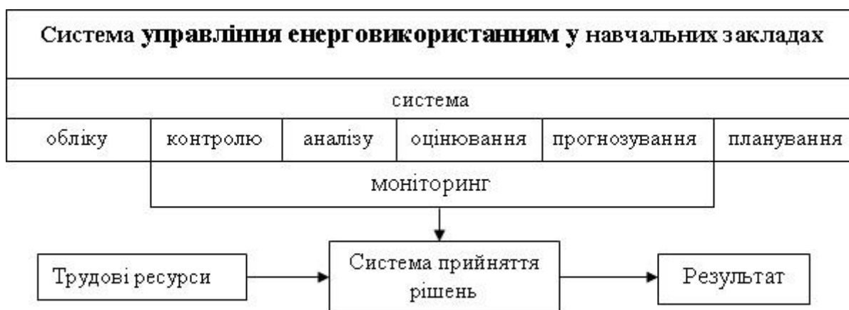
Рис. 1.6. Функціональна схема управління енерговикористанням НЗ
