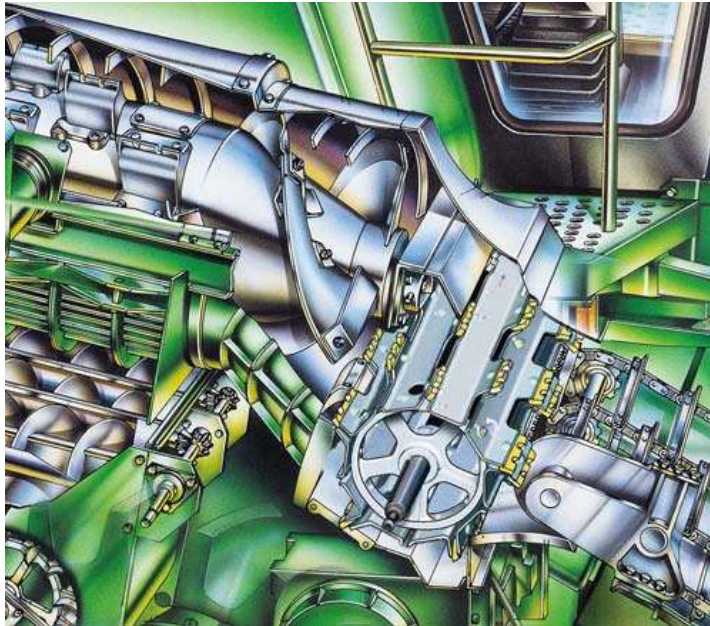
Рис. 4.2. Система обмолоту STS комбайна John Deere 9860
