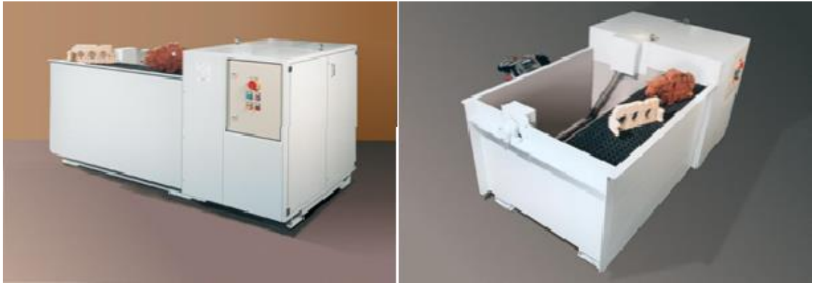
Рис 1.11 – Установка для фарбування стержнів КТМ 900
