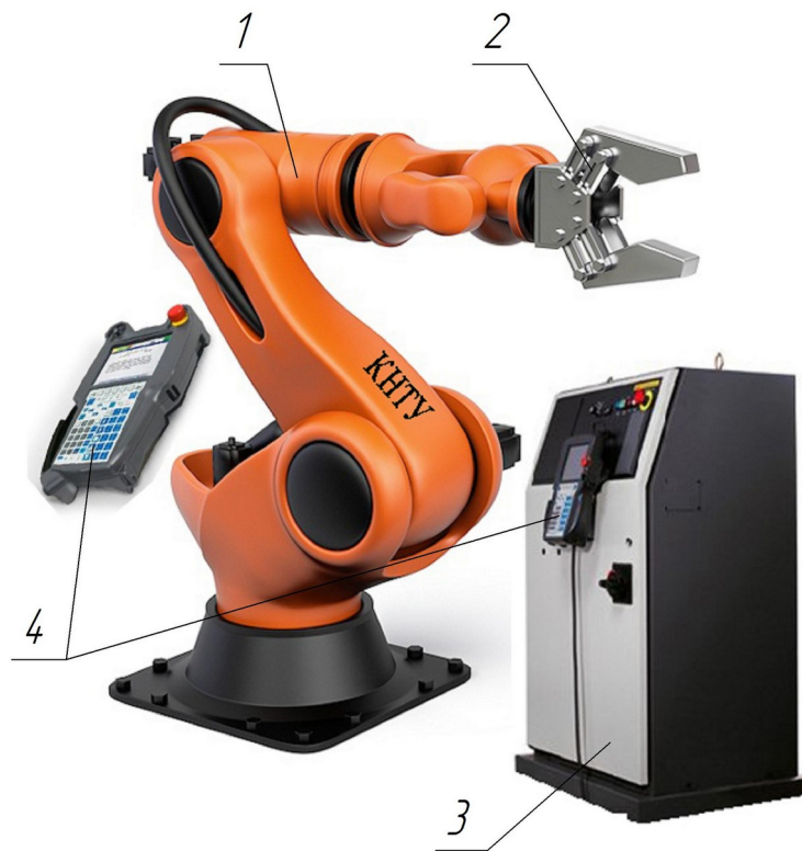
Рис.1.1. Основні складові ПР, де: 1 – промисловий робот; 2 – ЗП робота; 3 – блок керування; 4 – пульт керування.
