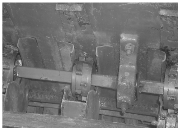
Рисунок 2 - Корозія зернотукового ящика сівалки СЗ-3,6
