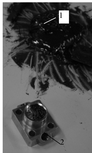
Рисунок 2 - Нанесення пастоподібного металполімера на поверхню вставки
