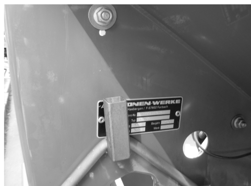
Рисунок 4 - Невдале розміщення таблички маркування сівалки Amazone (на стійці колеса)
