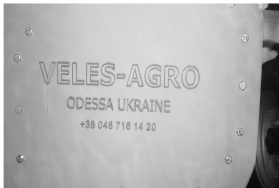
Рисунок 5 - Неповні реквізити маркувальної таблички сівалки СЗМ «Ника»
