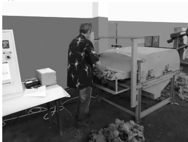
Рисунок 5 – Процес сухого очищення забрудненої вовни на малогабаритній тріпальній машині МТ-001А-12
