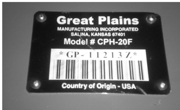
Рисунок 6 - Неповні реквізити маркувальної таблички сівалки Great Plains
