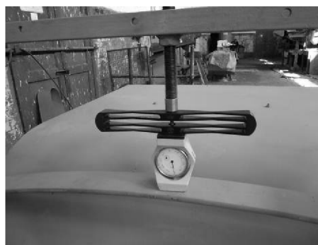
б) динамометр зразковий переносний ДОСМ-3-0,2
