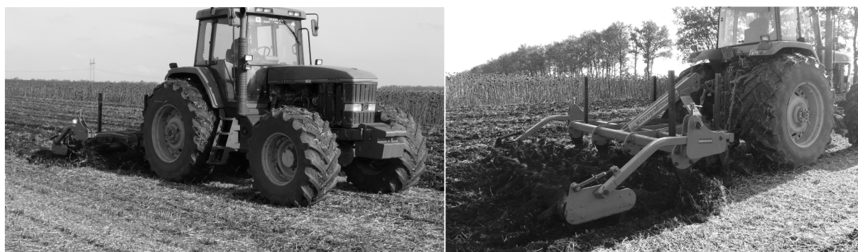
Рисунок 3 – Робочий процес чизеля навісного ЧН-4 в господарських умовах
