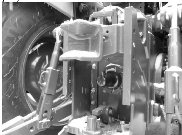
Рисунок 3 – Внешний вид места установки и механизма навешивания трактора Claas модели AXOS [8]
