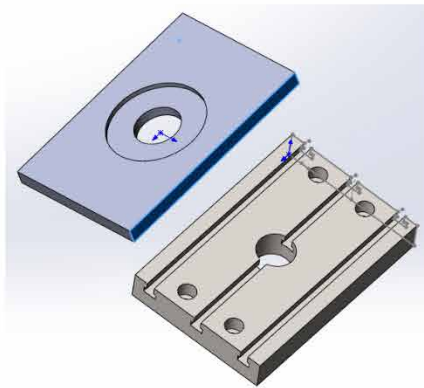
Рисунок 4.6 – Тверdotільні моделі деталей стола пресу та нижньої плити компенсатора в САПР SolidWorks
