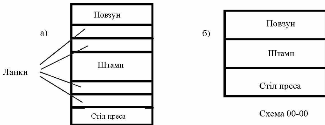
Рисунок 3.2 – До формування схеми компенсації: а) – загальна структурна схема; б) – приклад кодування схеми жорсткого кріплення штампа
