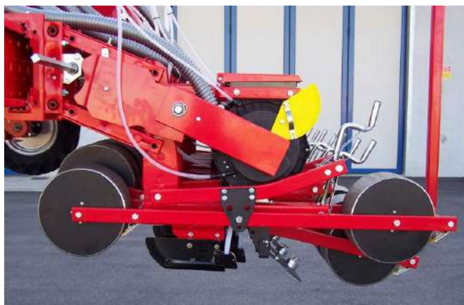
Рис. 3.2. Посівна секція MSO з одним висівним апаратом Magicsem [13–14]
