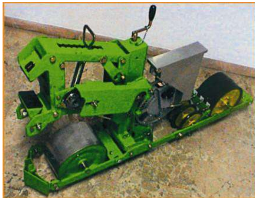
Рис. 3.8. Посівна секція Calibra Tris
