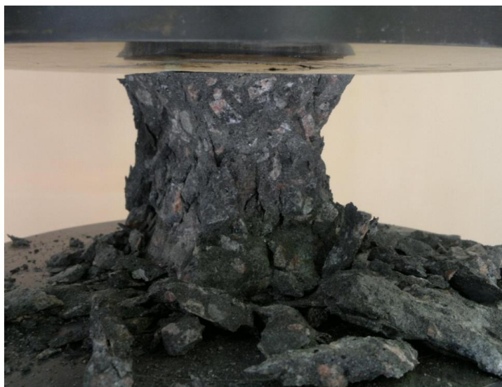
Рисунок 2.13 – Вигляд зруйнованого кубика з високоміцного бетону
