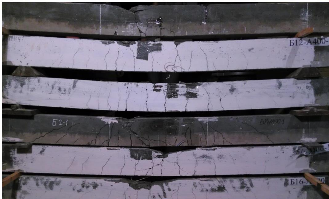
Рисунок 2.17 - Зображення зруйнованих балок з арматурою класу А400 діаметром 12, 14 та 16 мм.
