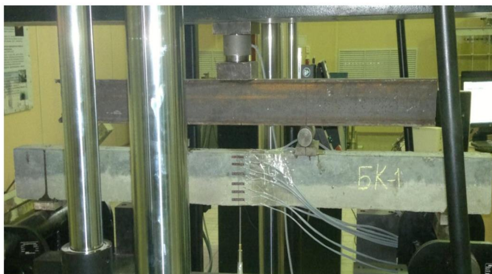
Рисунок 2.12 – Загальний вигляд установки залізобетонної балки на пресі.
