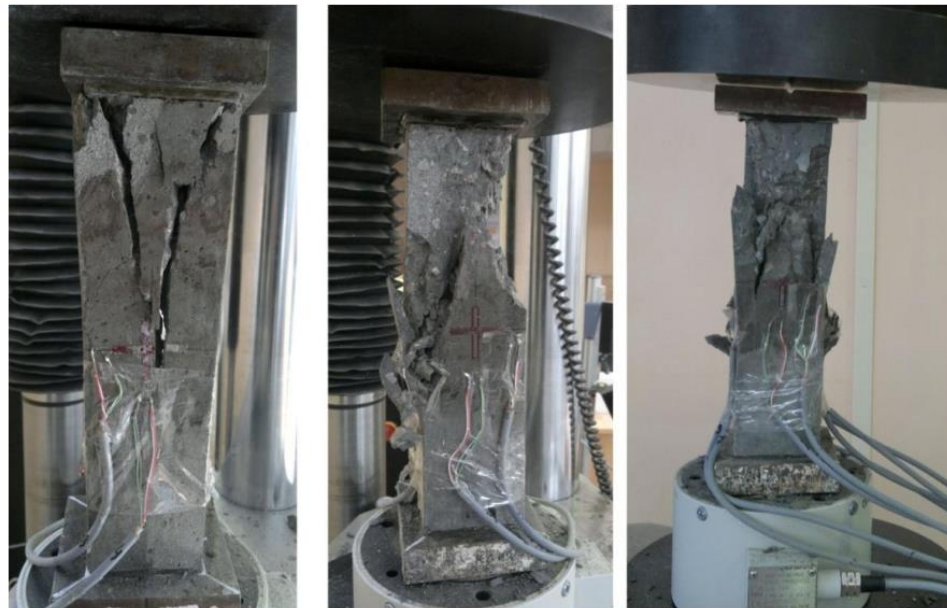
Рисунок 2.14 - Зруйнована призма з високоміцного бетону
