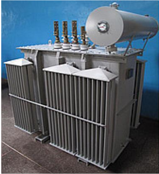
Рис. 5.1 - Зовнішній вигляд та основні технічні характеристики ТР ТМН-6300/35/10
