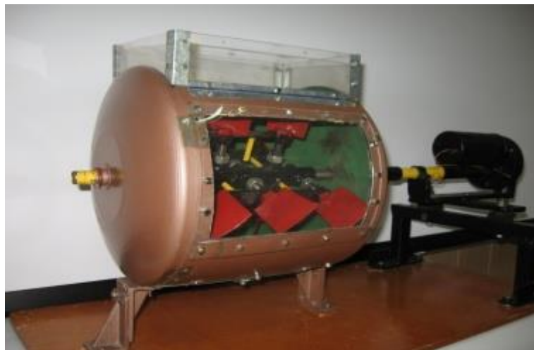
Рис. 2.5. Експериментальна установка з плоскими лопатями
