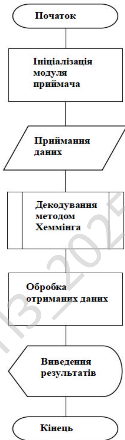
Рисунок 4.4 - Блок-схема роботи приймача
