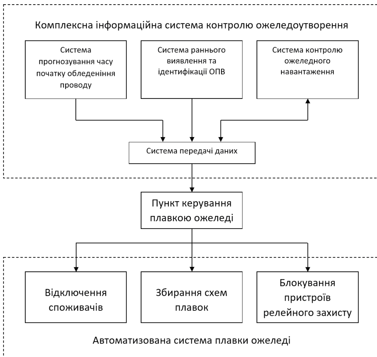
Рисунок 1.2 – Система захисту ПЛ від ожеледоутворення
