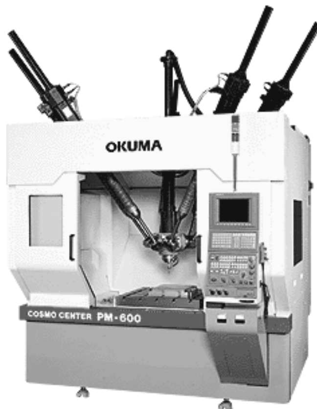
Рис. 1.10. Загальний вигляд верстата-гексапода мод. COSMOCENTER PM-600 фірми OKUMA (Японія)
