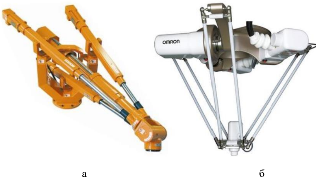
Рис. 1.3. Загальний вигляд роботів Tricept robot (а) і Delta robot (б)
