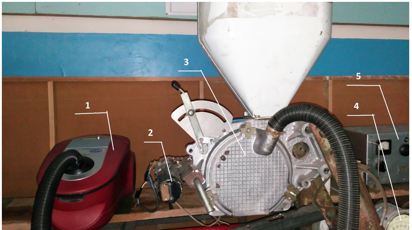
1 – пиломок «VCC4140V38», 2 - електромотор, 3 – модернізований висівний апарат, 4 – манометр, 5 – регулятор-випрямляч струму ВСА-111К.
